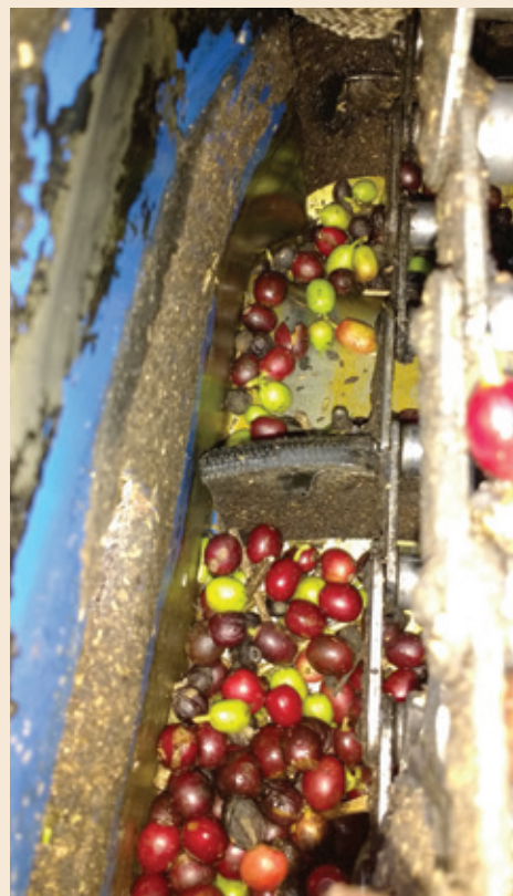
Obstruções de espaços, onde os grãos colhidos passam, podem promover o descascamento e a quebra dos mesmos
