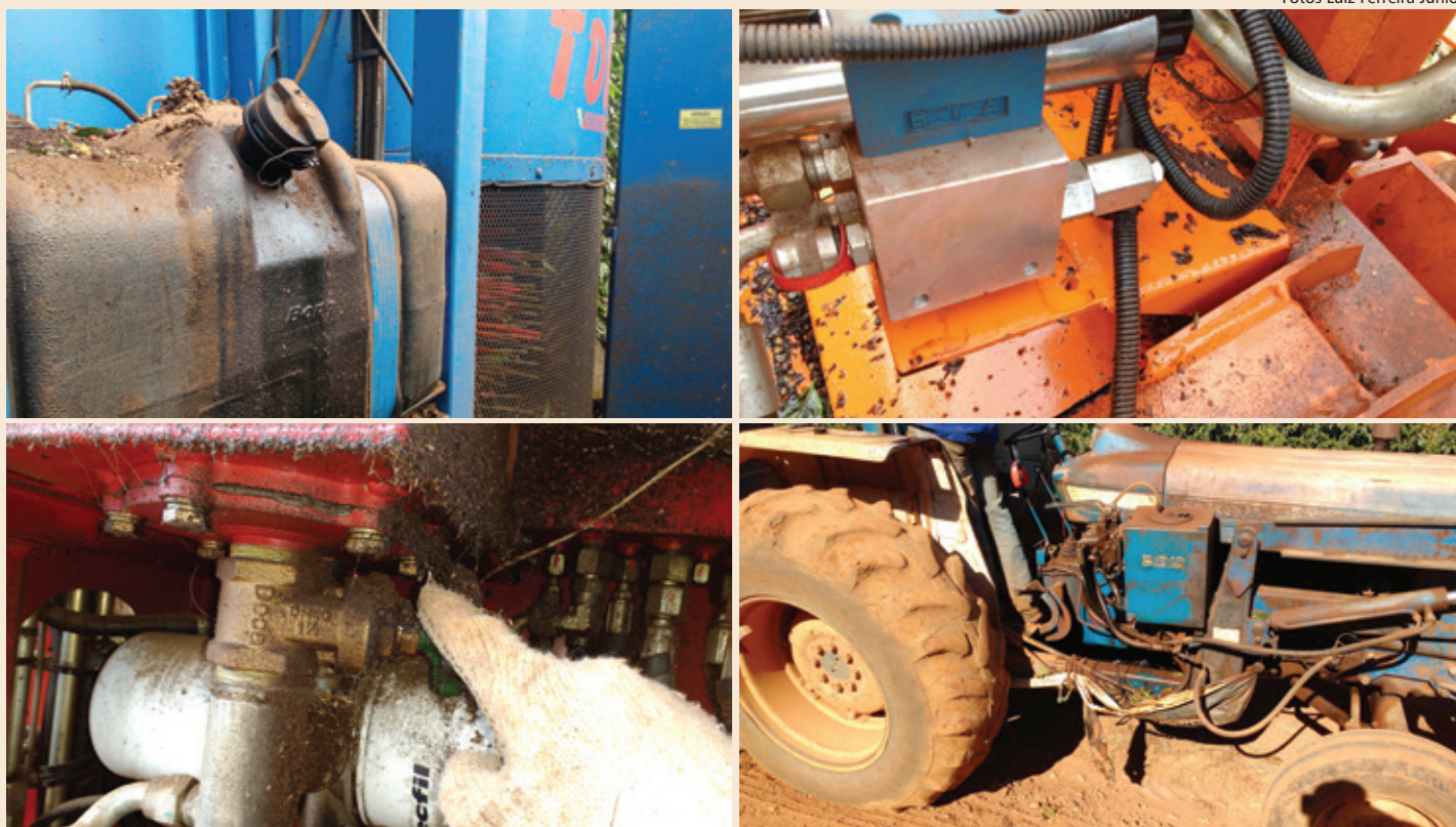
Exemplos de resíduos químicos provenientes de diversos sistemas e componentes de colhedoras e tratores que contaminam o café durante a colheita
