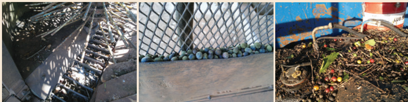
Exemplos de resíduos de café alojados em diferentes partes das colhedoras que muitas vezes ficam acumulados de uma safra para outra
