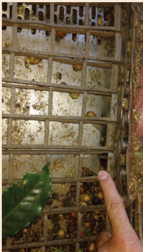
Obstruções de espaços, onde os grãos colhidos passam, podem promover o descascamento e a quebra dos mesmos
