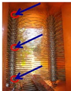
Figura 2. Posição das hastes ensaiadas ao longo do cilindro.
