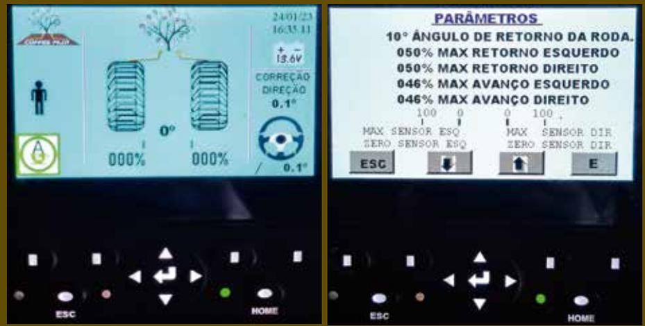
A tela IHM permite que o operador acompanhe o movimento de giro da roda dianteira e, por segurança, em qualquer necessidade ou emergência
