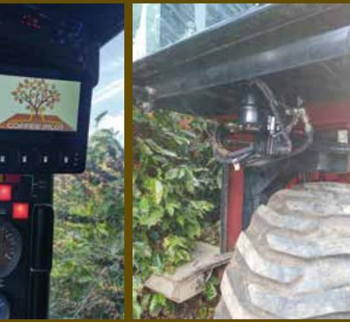
sensores (A), uma IHM (Interface Homem Máquina) função de tela e módulo (B) e direção eletrônica (C)
